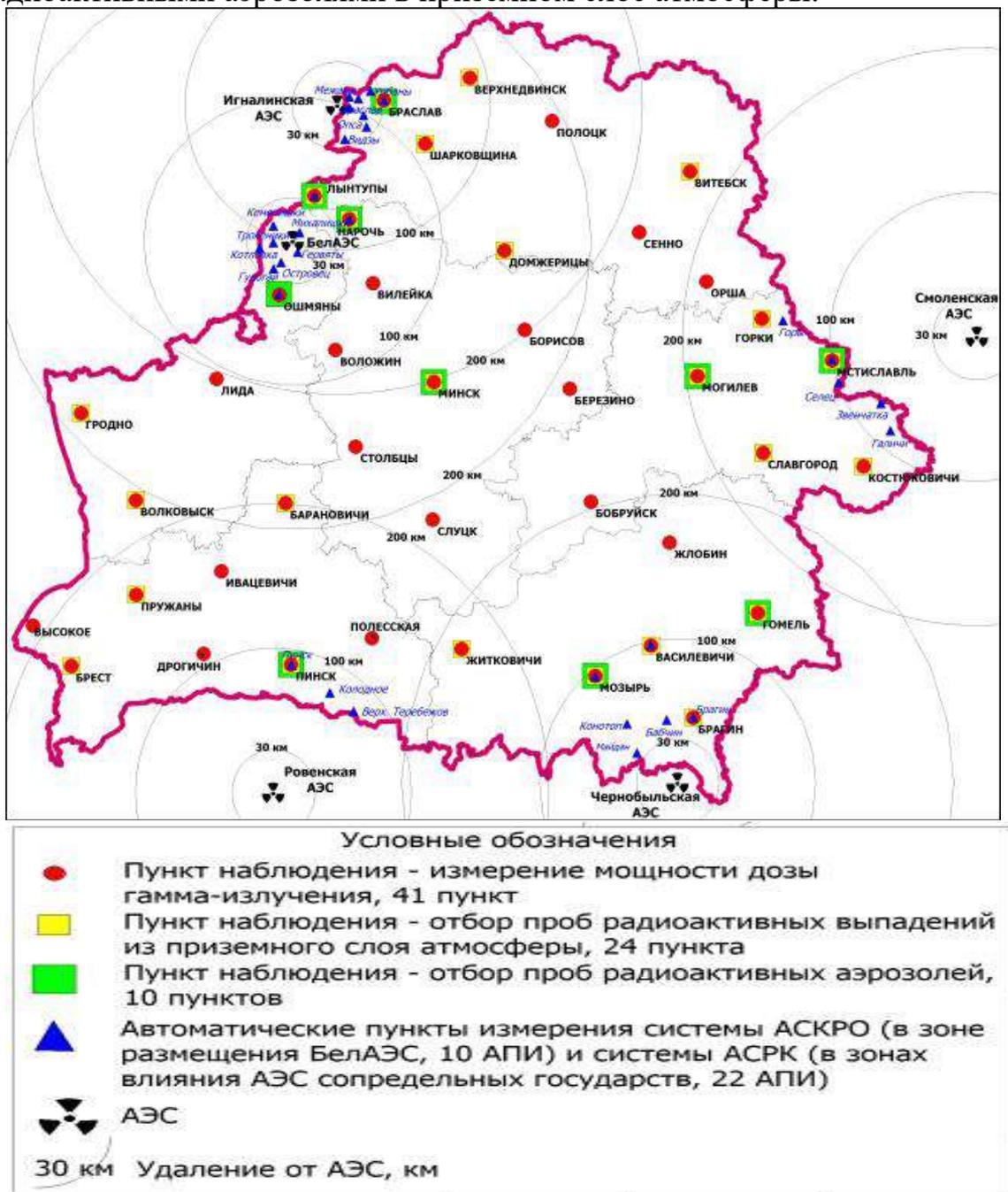
Рисунок 4.24- Схема размещения пунктов радиационного мониторинга
